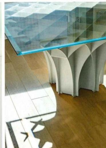
1 中庭の開口部は、タイルのサイズに基づいて大きさやバランスが決定されている。この緻密さは谷口建築に一貫するものだ。2 「シェイズ・ドム」の背もたれは、中国の明時代の椅子を思わせる。3 「カテドラル・テーブル」の脚部はスリットを入れた板で構成。1980年代、複雑な構造をコンピューターの力を借りずに実現した。4 ダイニングとリビングルームやその上の小部屋を結ぶ階段。視界が広がる空間構成も、この家の特徴の一つ。
